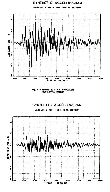
Fig. 4 SYNTHETIC ACCELEROGRAM VERTICAL MOTION
