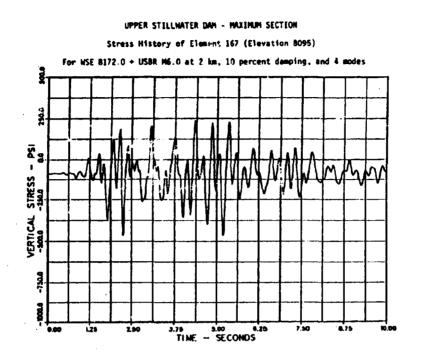
Fig. 12 VERTICAL STRESS HISTORY + MAXIMUM SECTION DOWNSTREAM FACE - ELEVATION 1095 - HIGH WATER
