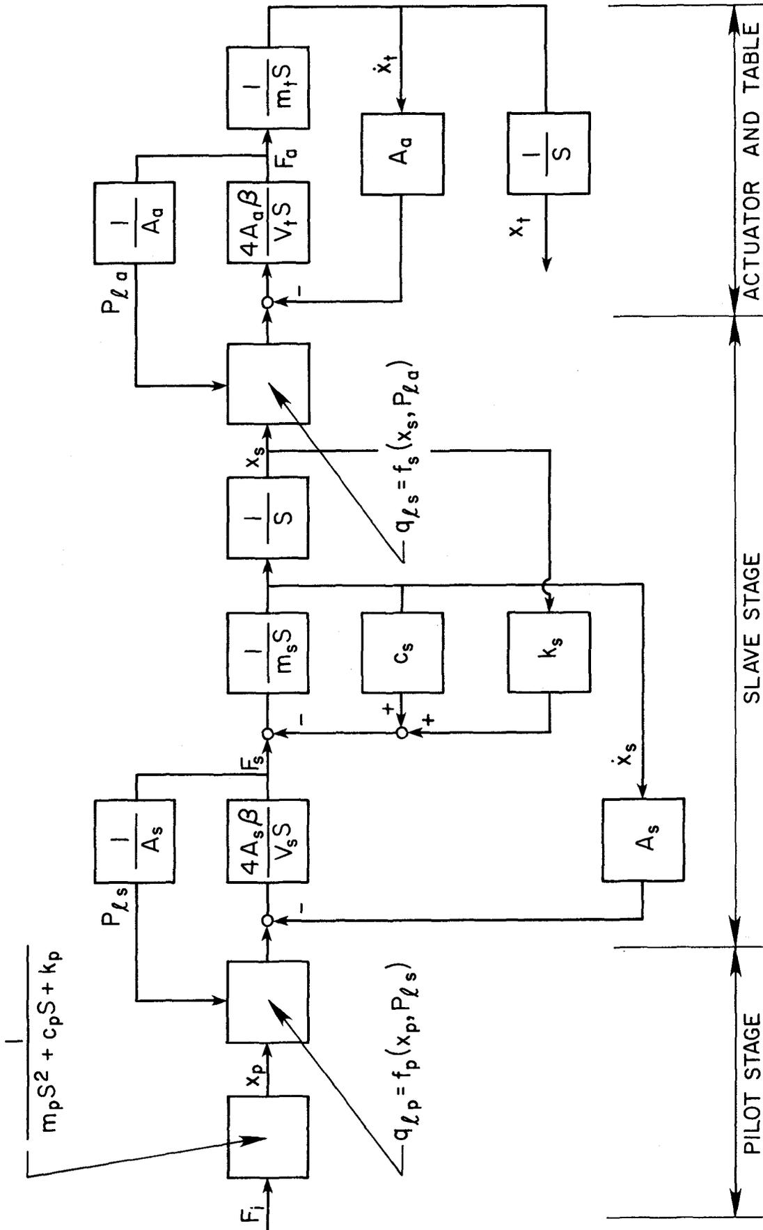
FIG. 3.2 IDEALIZED SERVOVALVE-ACTUATOR SYSTEM
