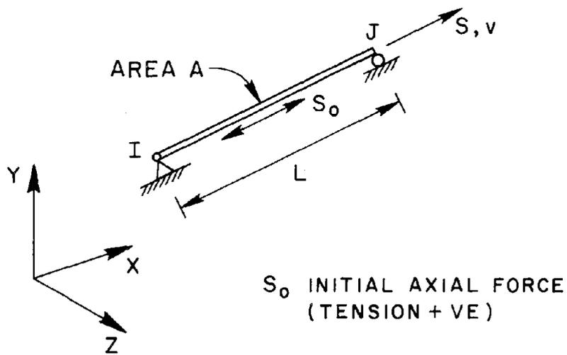
FIG. B1.1 TRUSS ELEMENT
