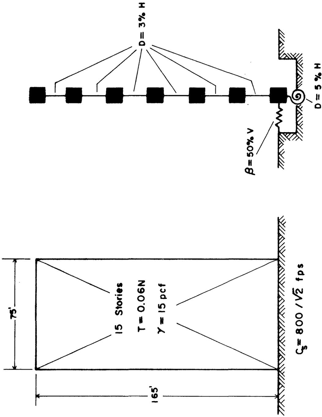
FIGURE 1 : TYPICAL SOIL STRUCTURE SYSTEM
