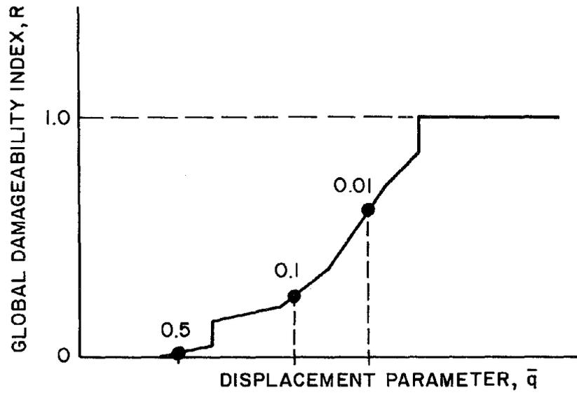
FIGURE 7.2 DAMAGEABILITY FOR EARTHQUAKES OF VARYING PROBABILITY OF OCCURRENCE
