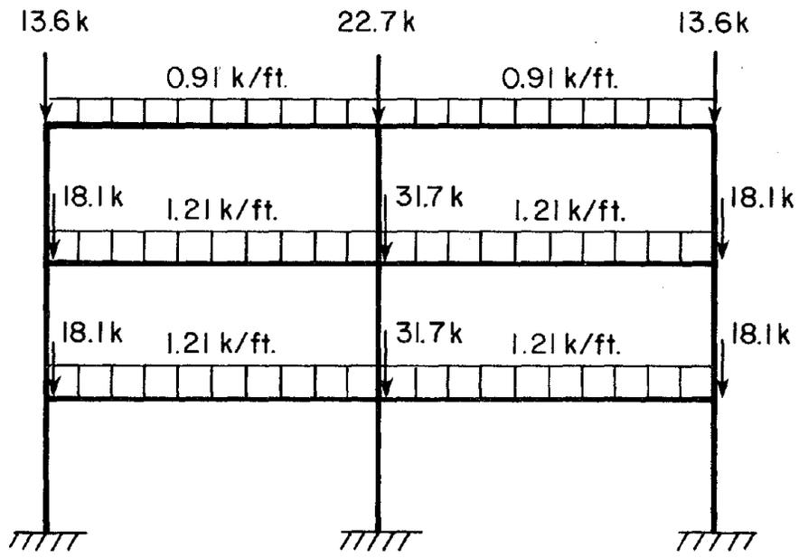
FIGURE 7.10 GRAVITY LOAD DISTRIBUTION
