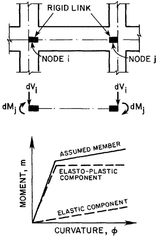
FIGURE 4.3 TYPICAL BEAM MODEL
