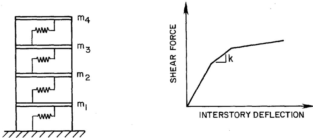
FIGURE 4.1 TYPICAL MODEL FOR A FIRST SCREENING
