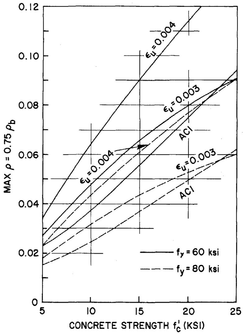
FIG. 2 MAXIMUM STEEL RATIO, MAX  $\rho$
