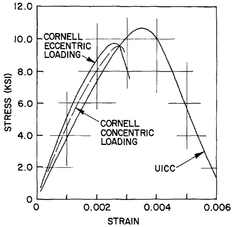
FIG. 1 TYPICAL STRESS-STRAIN CURVES
