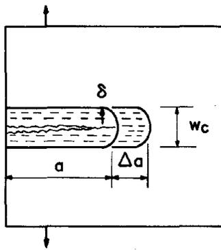
Fig. 5 Crack Band Propagation
