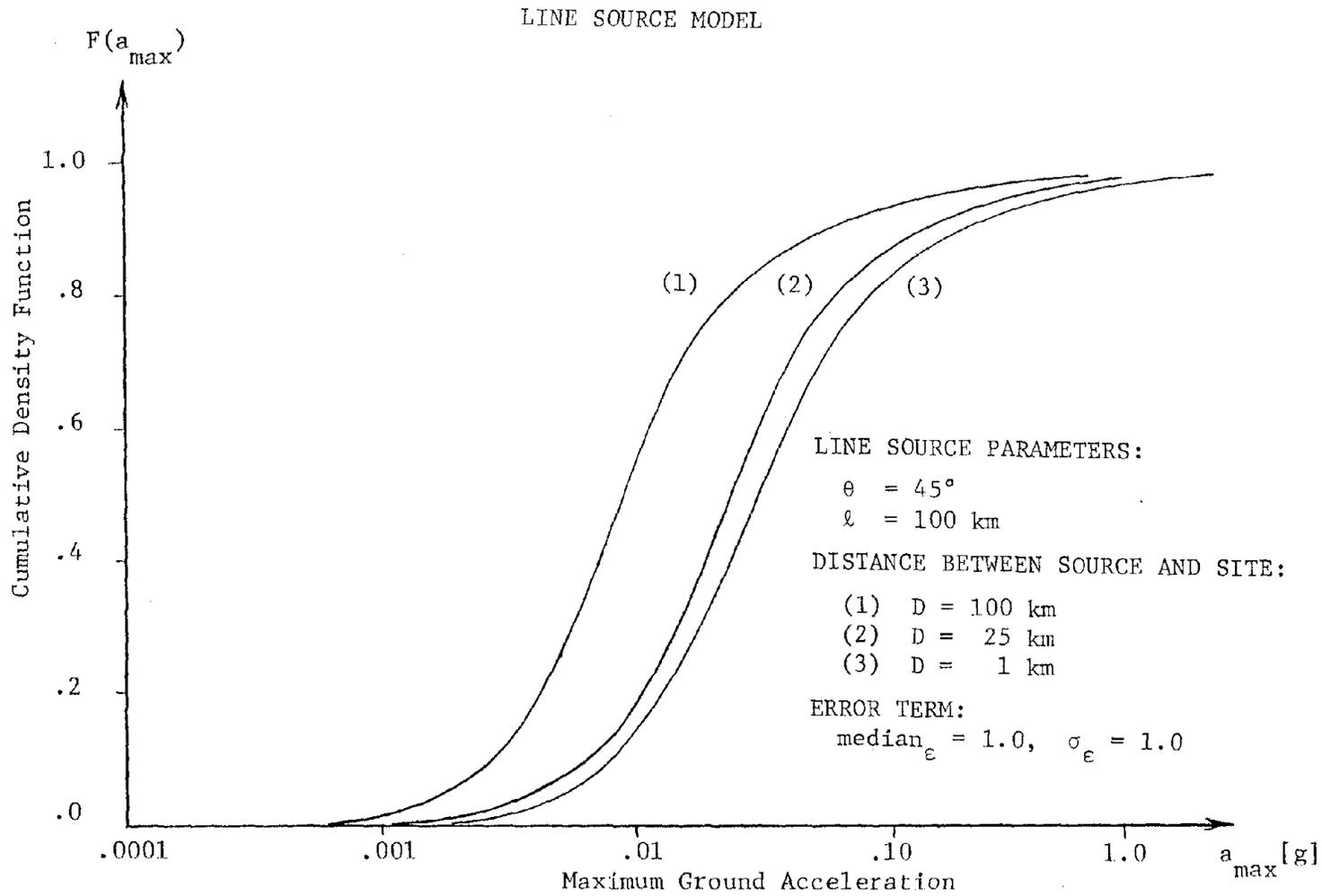
FIGURE 5-10. CUMULATIVE FUNCTION OF GROUND ACCELERATION
