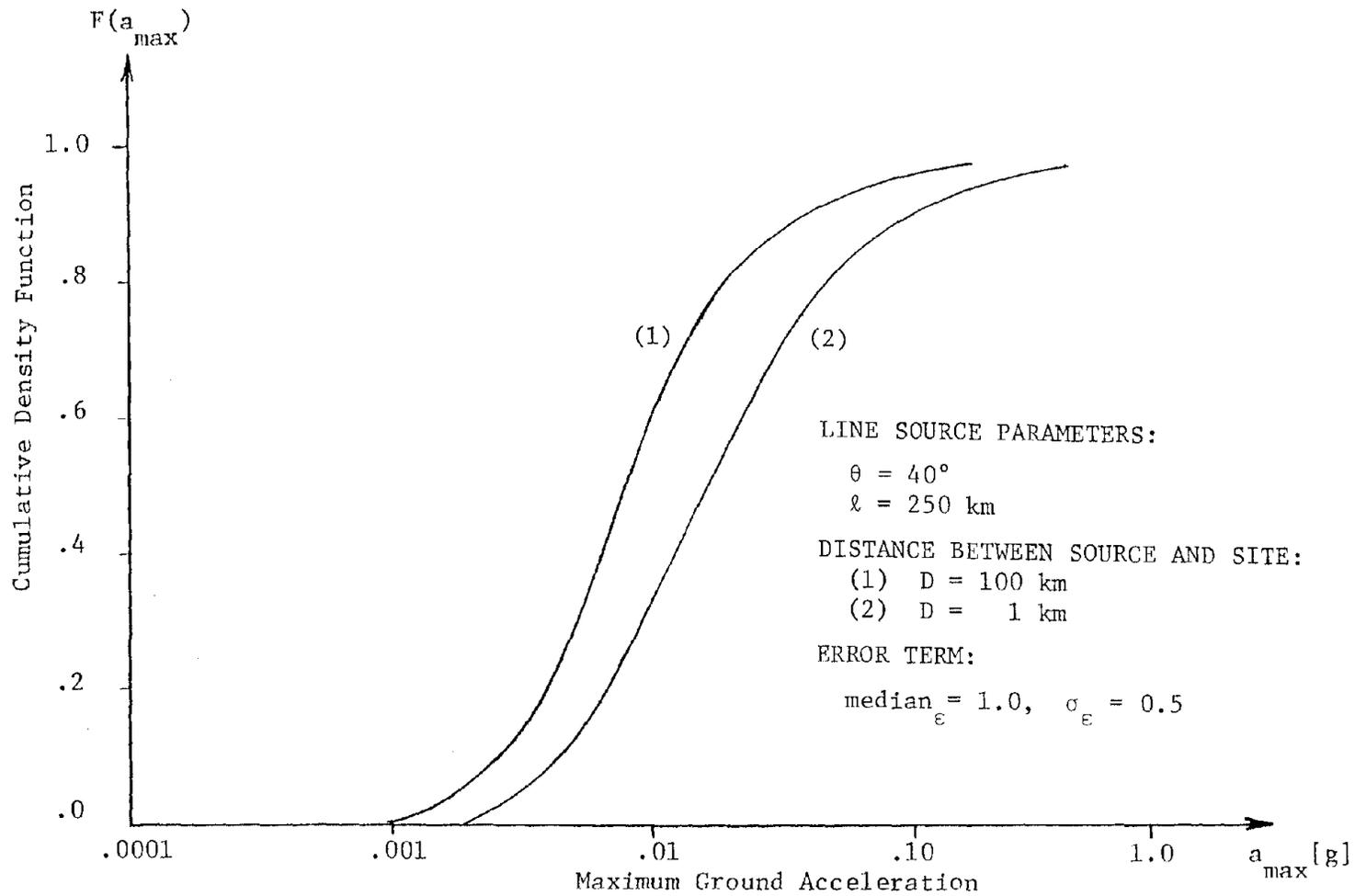
FIGURE 5-15. CUMULATIVE FUNCTION OF GROUND ACCELERATION
