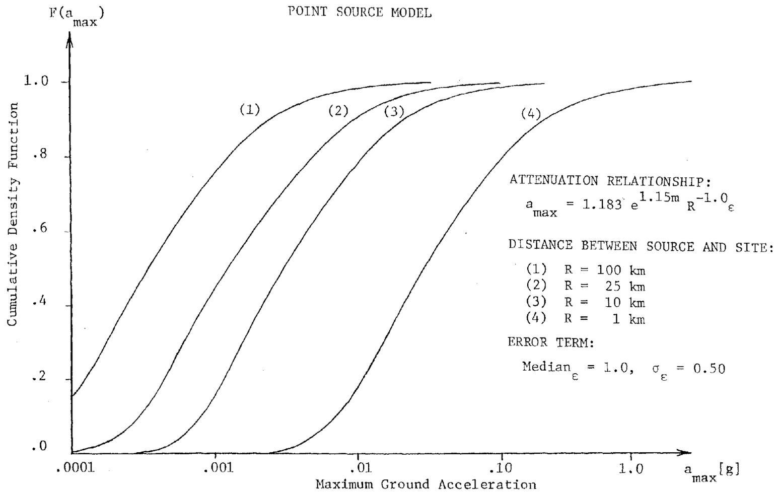
FIGURE 5-5. CUMULATIVE FUNCTION OF GROUND ACCELERATION
