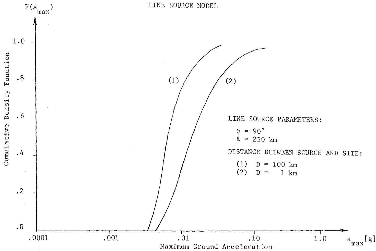
FIGURE 5-17. CUMULATIVE FUNCTION OF GROUND ACCELERATION
