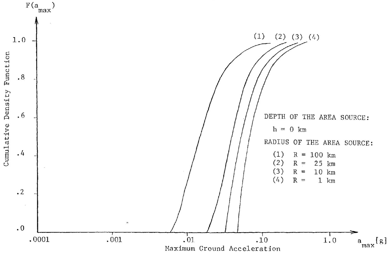
FIGURE 5-20. CUMULATIVE FUNCTION OF GROUND ACCELERATION
