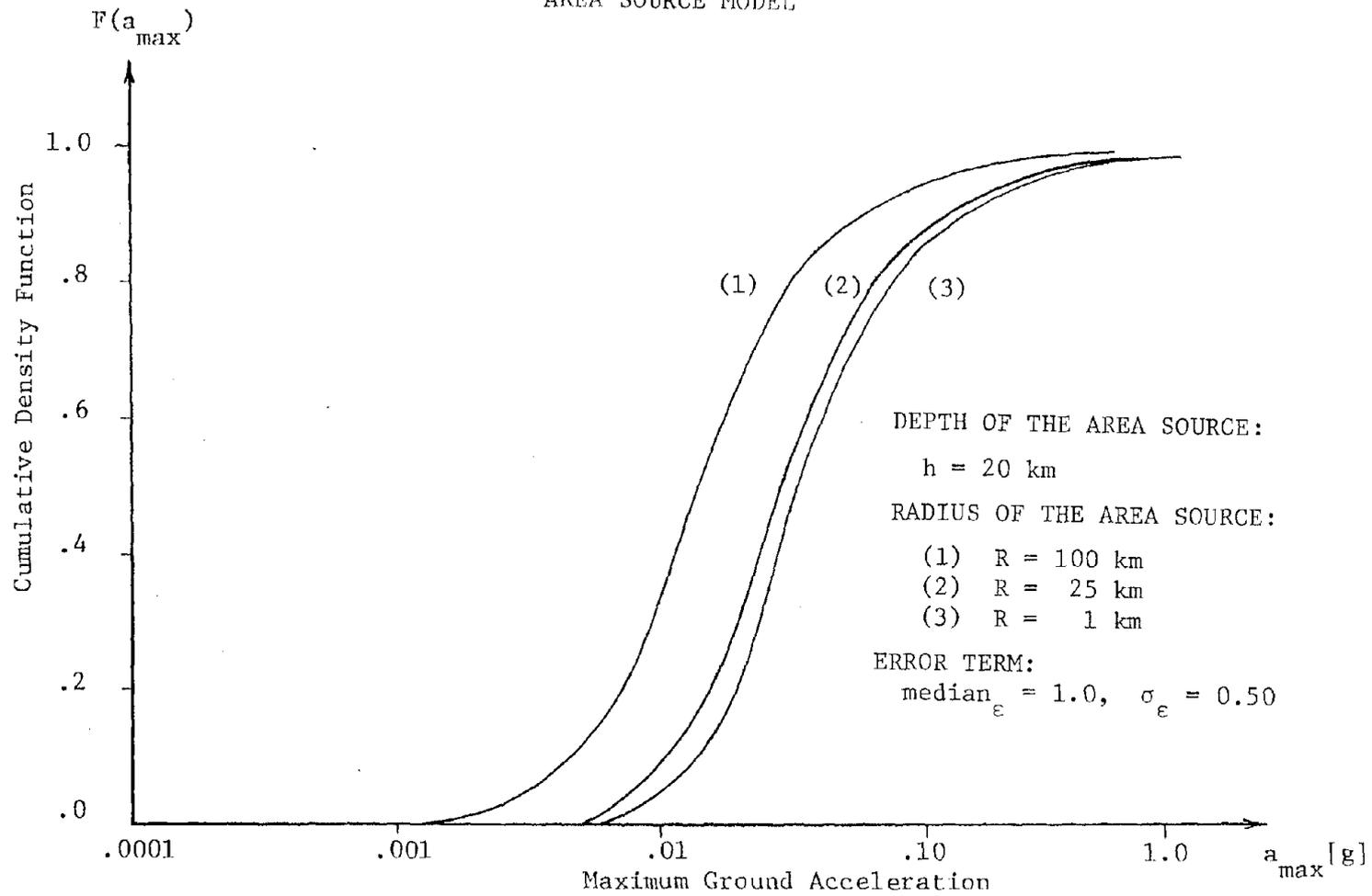
FIGURE 5-24. CUMULATIVE FUNCTION OF GROUND ACCELERATION
