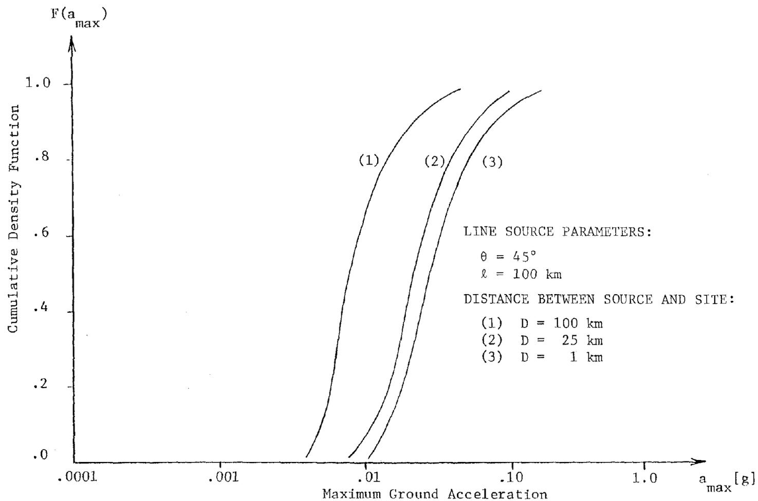
FIGURE 5-8. CUMULATIVE FUNCTION OF GROUND ACCELERATION
