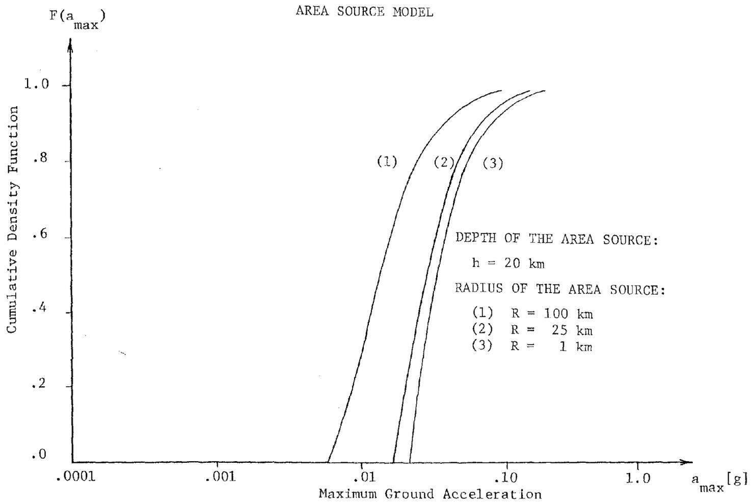
FIGURE 5-21. CUMULATIVE FUNCTION OF GROUND ACCELERATION
