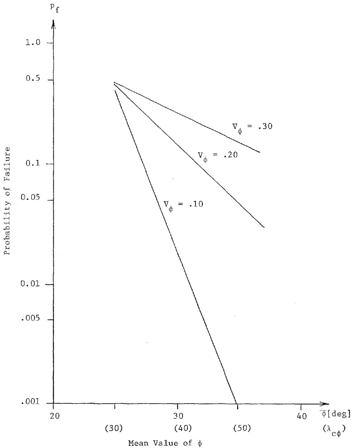
FIGURE 4-2. EFFECT ON THE PROBABILITY OF FAILURE OF THE STATISTICAL VALUES OF  $\phi$
