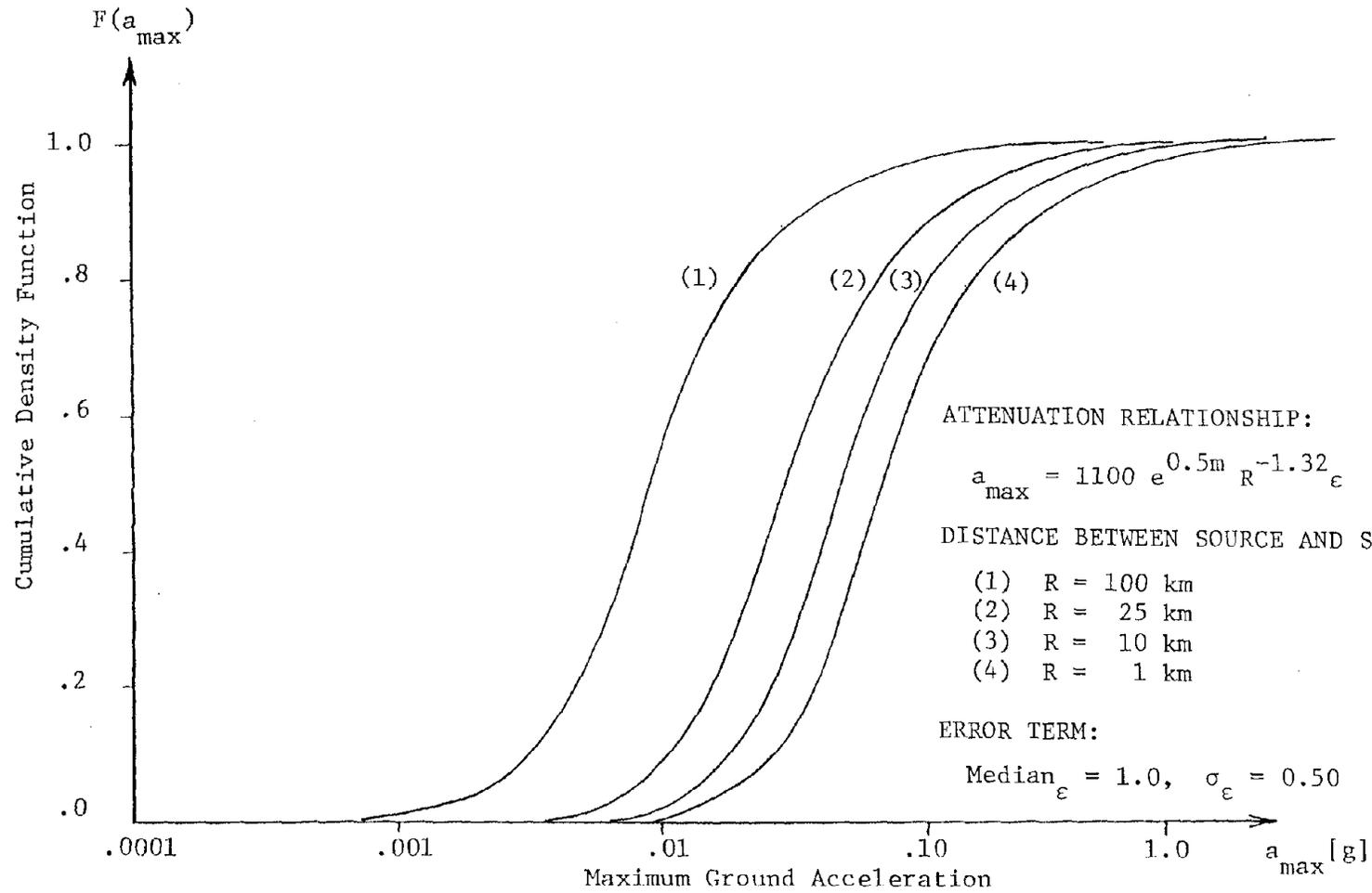
FIGURE 5-3. CUMULATIVE FUNCTION OF GROUND ACCELERATION
