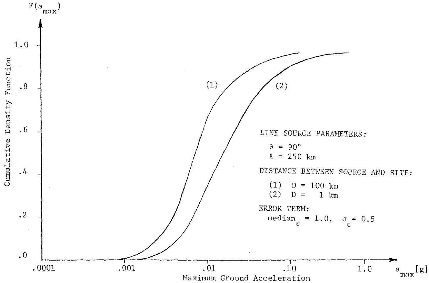
FIGURE 5-18. CUMULATIVE FUNCTION OF GROUND ACCELERATION
