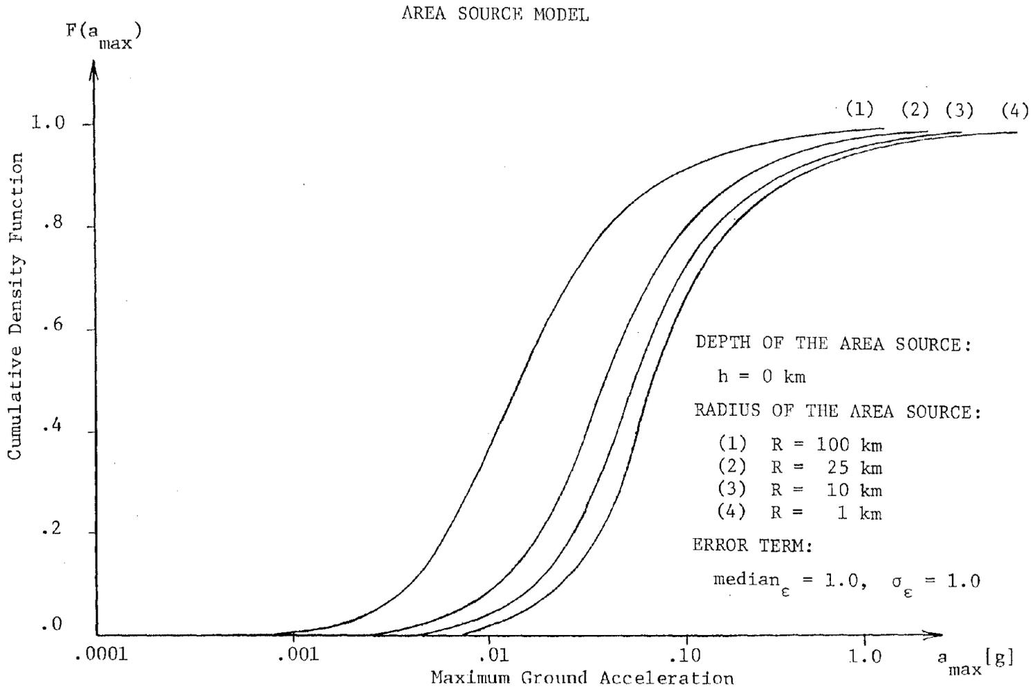
FIGURE 5-23. CUMULATIVE FUNCTION OF GROUND ACCELERATION
