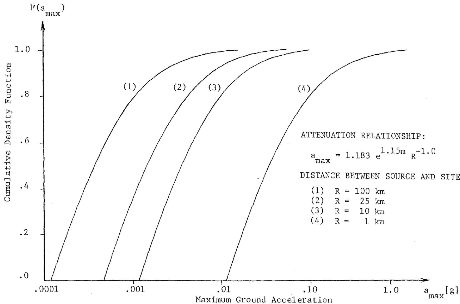
FIGURE 5-2. CUMULATIVE FUNCTION OF GROUND ACCELERATION
