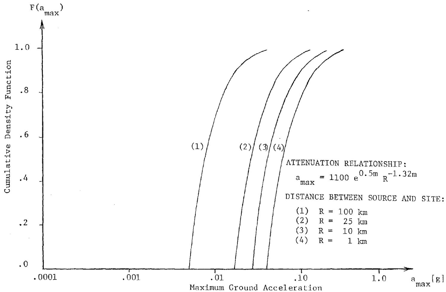
FIGURE 5-1. CUMULATIVE FUNCTION OF GROUND ACCELERATION
