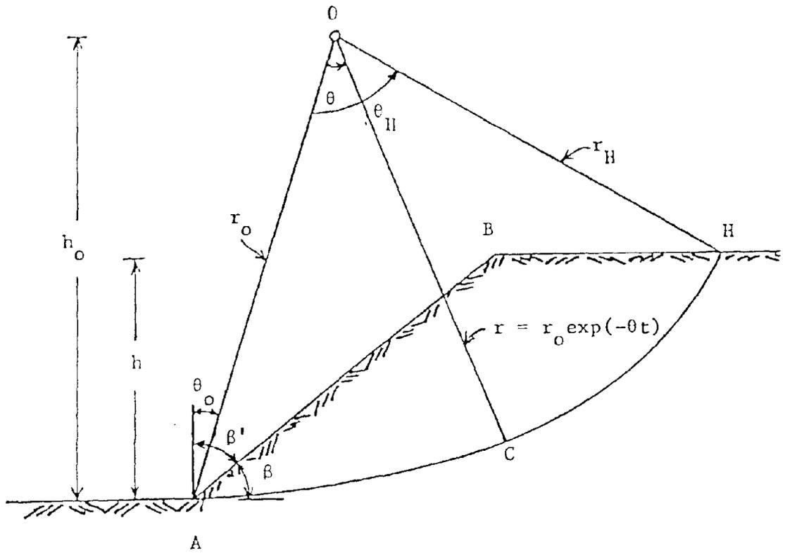
FIGURE 2-2. SHAPE OF FAILURE SURFACE
