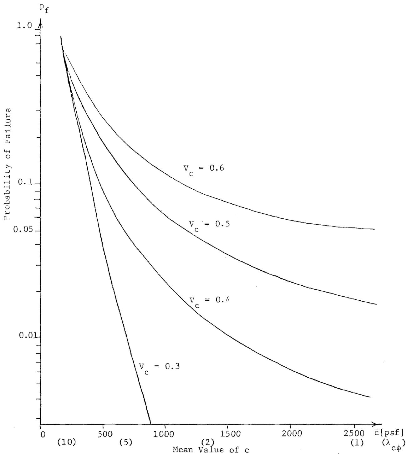
FIGURE 4-1. EFFECT ON THE PROBABILITY OF FAILURE OF THE STATISTICAL VALUES OF  $c$
