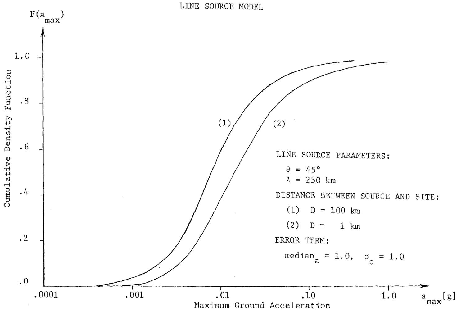
FIGURE 5-16. CUMULATIVE FUNCTION OF GROUND ACCELERATION
