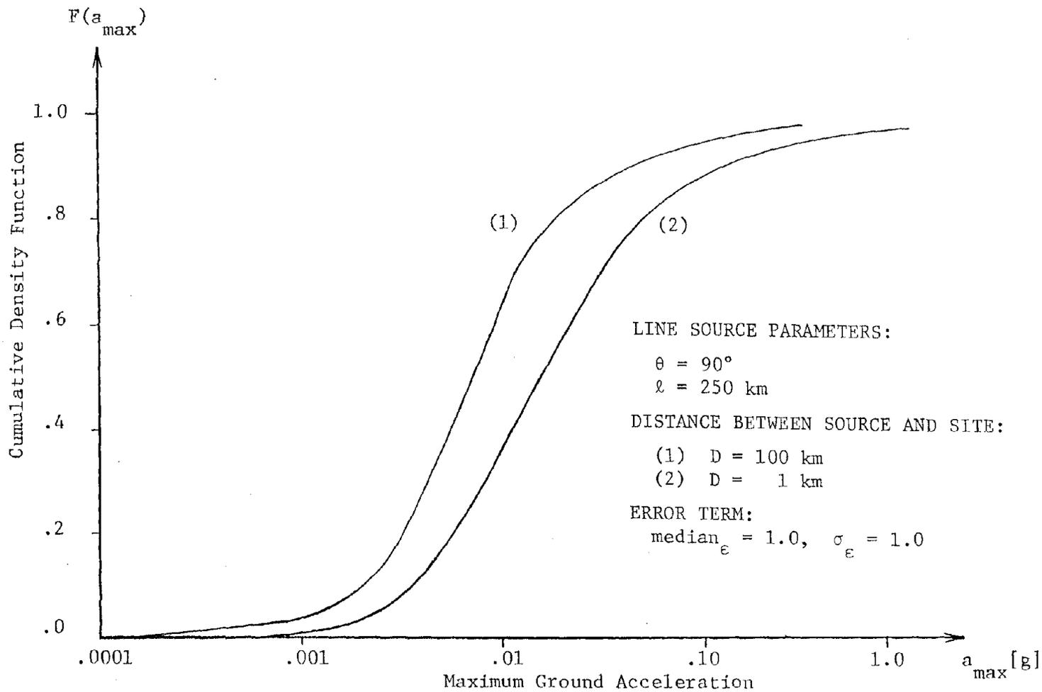
FIGURE 5-19. CUMULATIVE FUNCTION OF GROUND ACCELERATION
