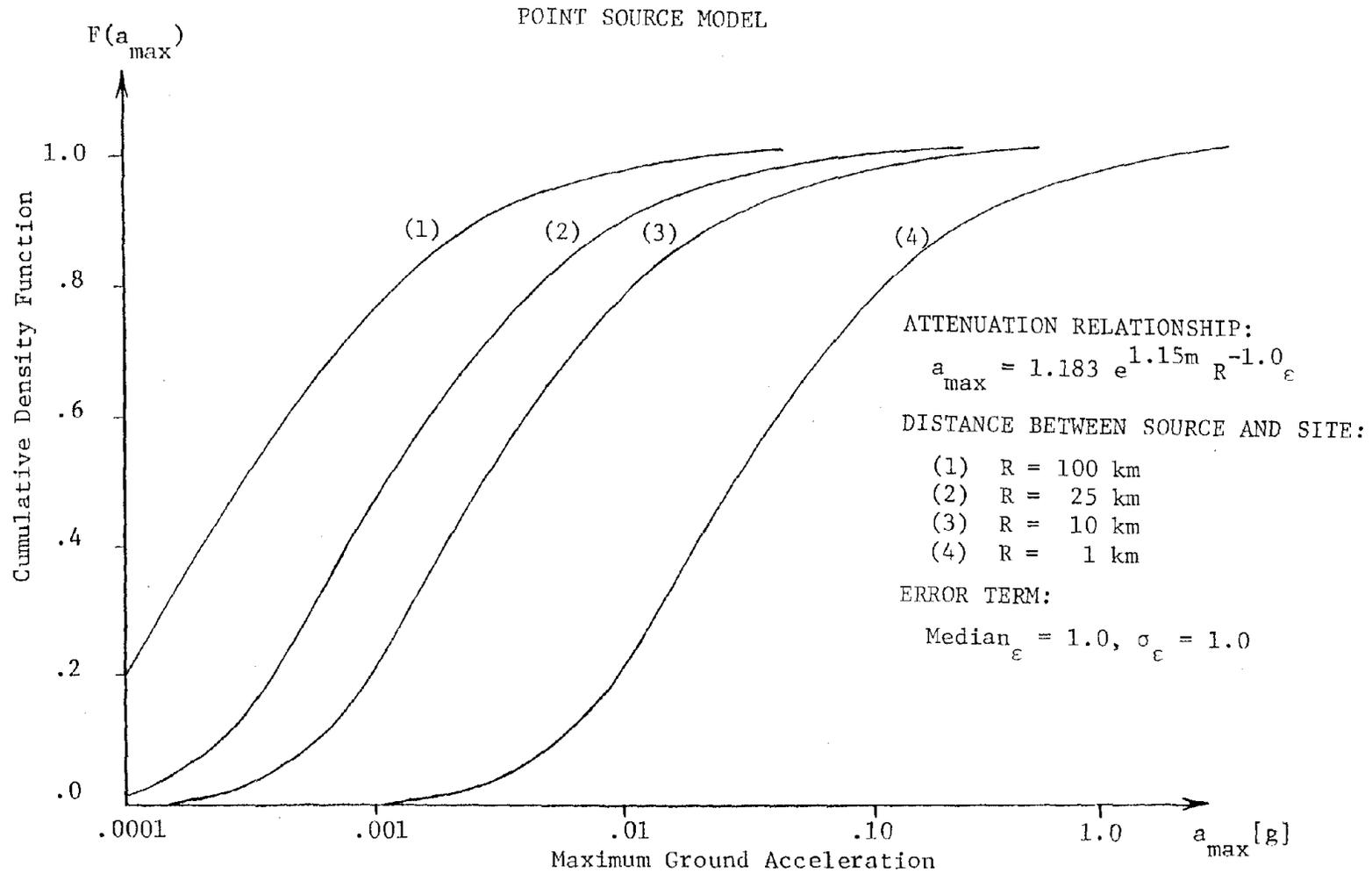
FIGURE 5-6. CUMULATIVE FUNCTION OF GROUND ACCELERATION
