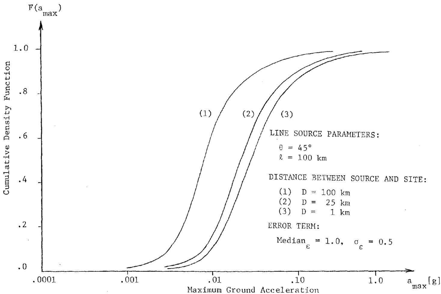
FIGURE 5-9. CUMULATIVE FUNCTION OF GROUND ACCELERATION
