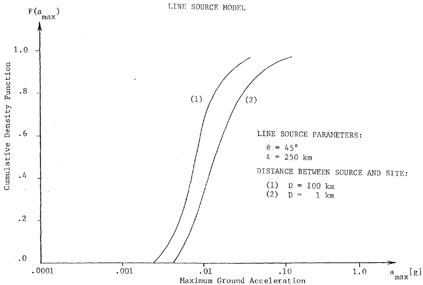
FIGURE 5-14. CUMULATIVE FUNCTION OF GROUND ACCELERATION
