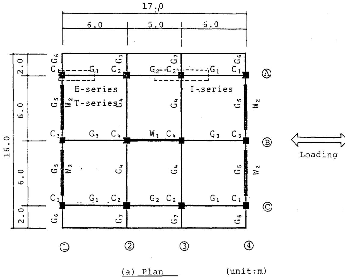
Fig. 1 : Full-Scale Structure
