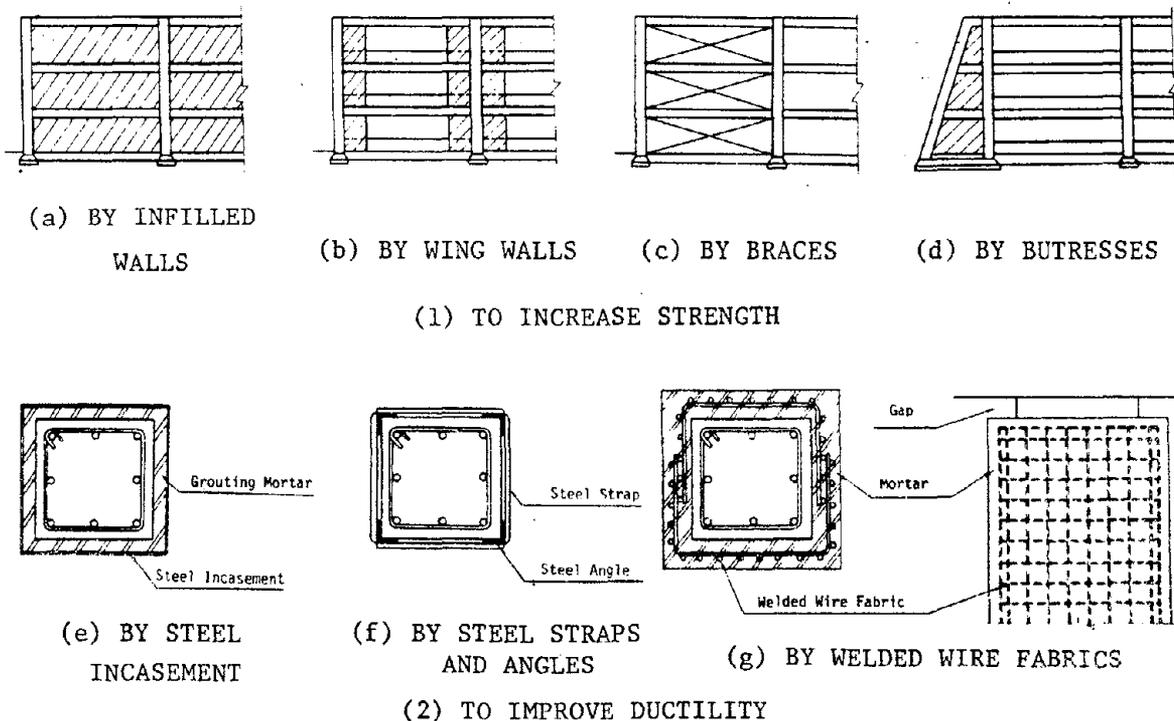
FIG. 4 TYPICAL CONSTRUCTION TECHNIQUES FOR SEISMIC STRENGTHENING
