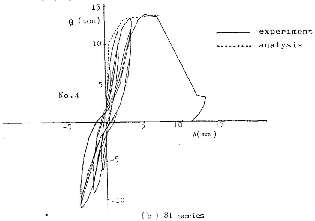
Fig. 4-4 Load-Reflection Curve
