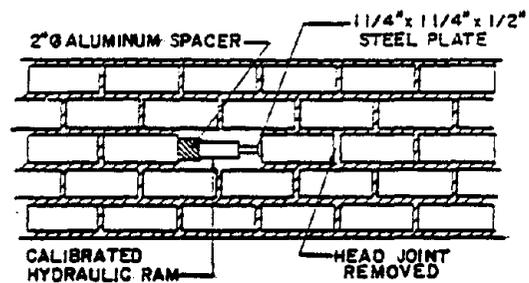
FIGURE 4 IN-PLACE JOINT SHEAR TEST
