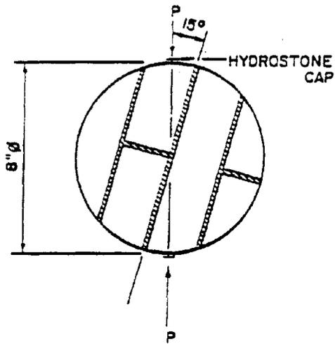
FIGURE 3 SHEAR-BOND TEST BY DIAMETRAL COMPRESSION
