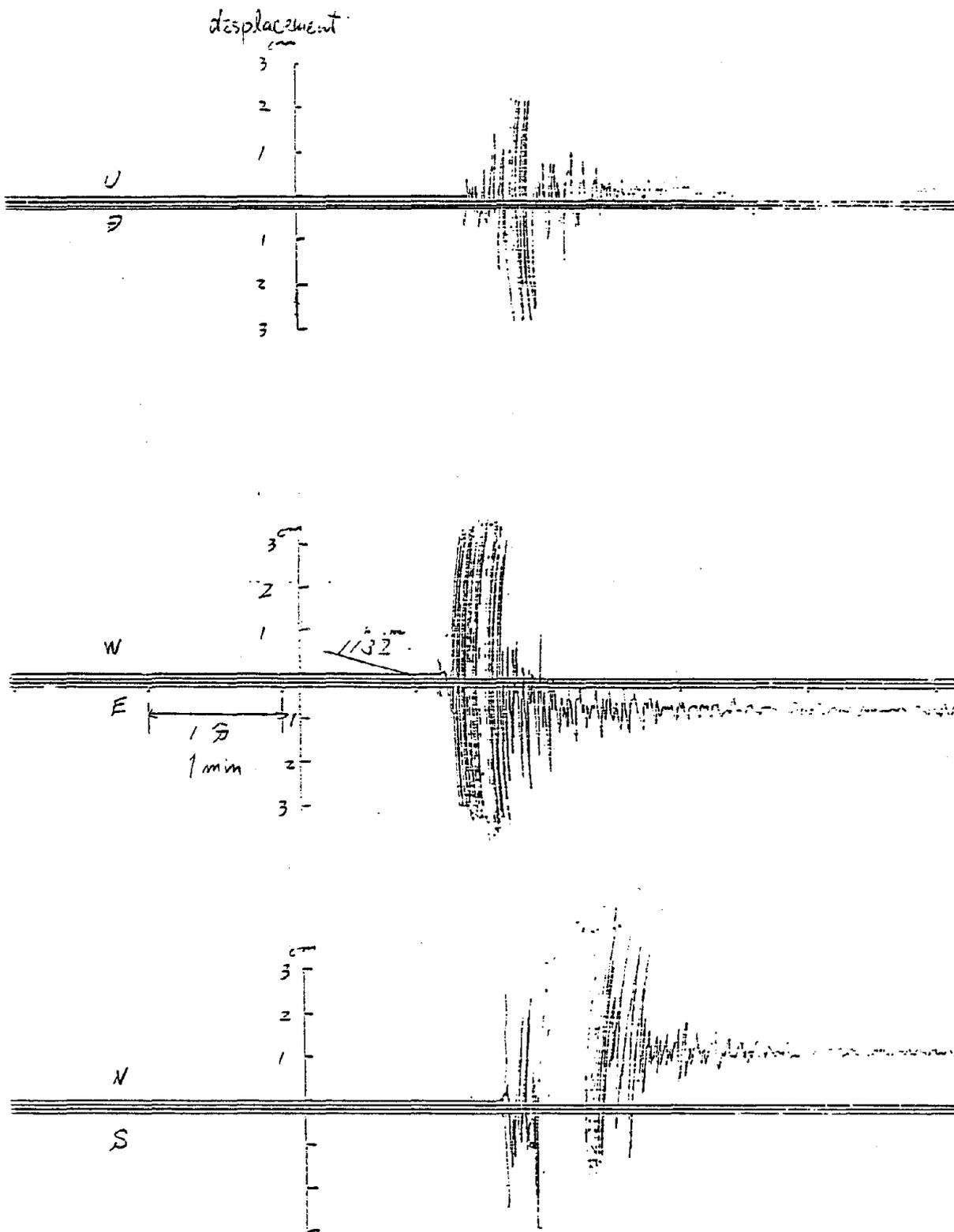
図 2.2 震度計 1 倍計の本震記録 (南河洲候所 昭和 52 年 3 月 21 日 11 時 27 分)
