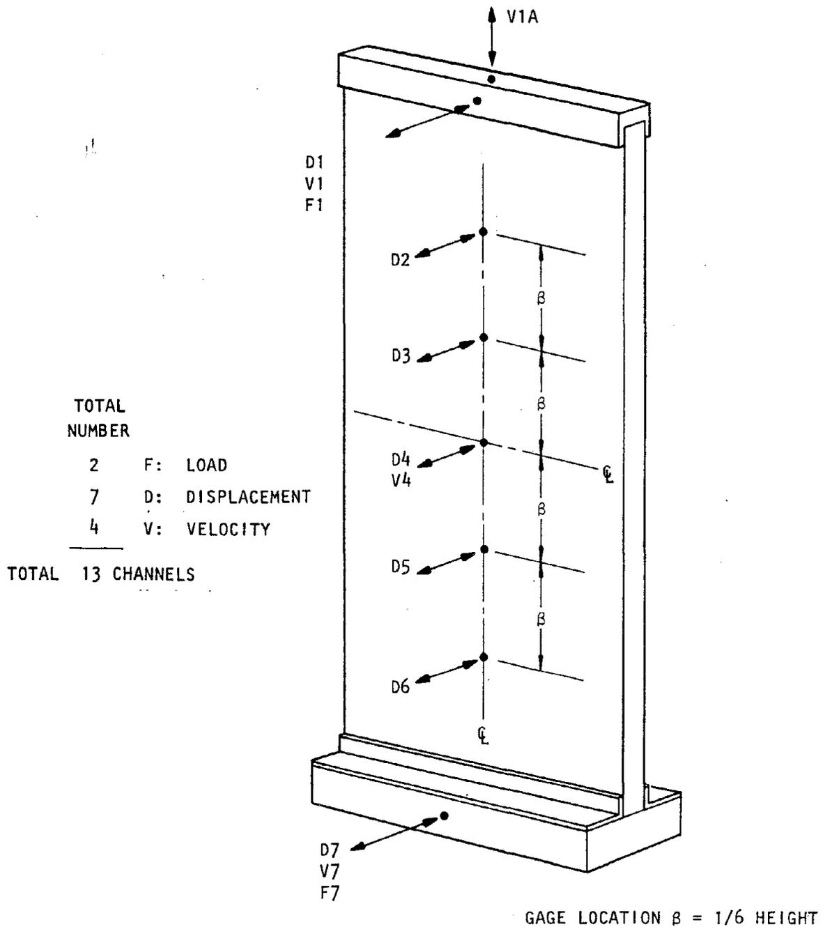
FIGURE 12. WALL INSTRUMENTATION
