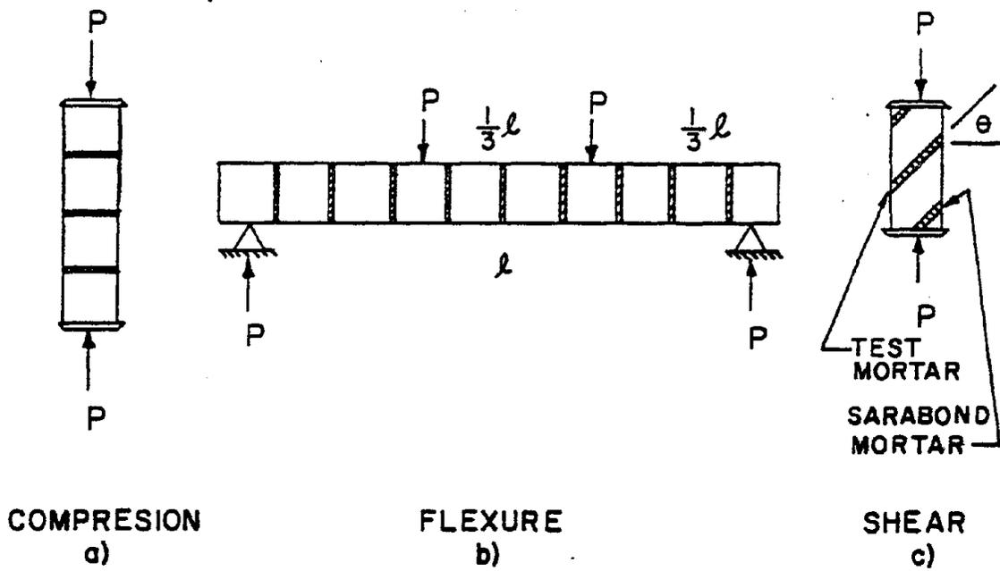
FIGURE 2 SMALL SCALE SPECIMAN TESTS
