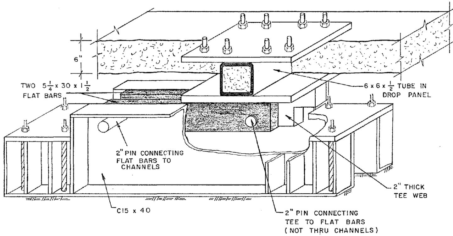
Fig. 2.43 Reaction assemblage
