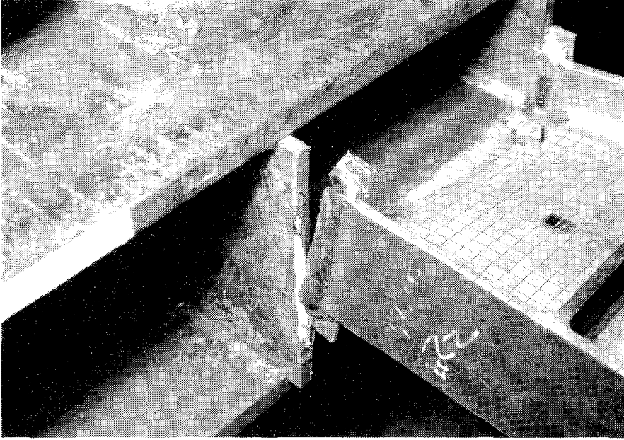
(d) Link-Column Connection - After Testing
